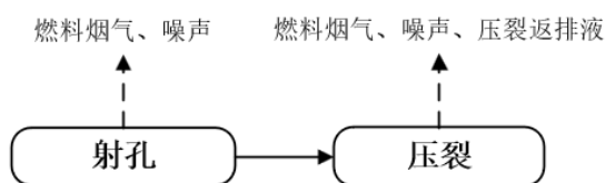
图3.5-3 储层改造工程施工工艺流程
